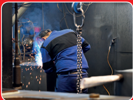
Ruční svařování kotlů
